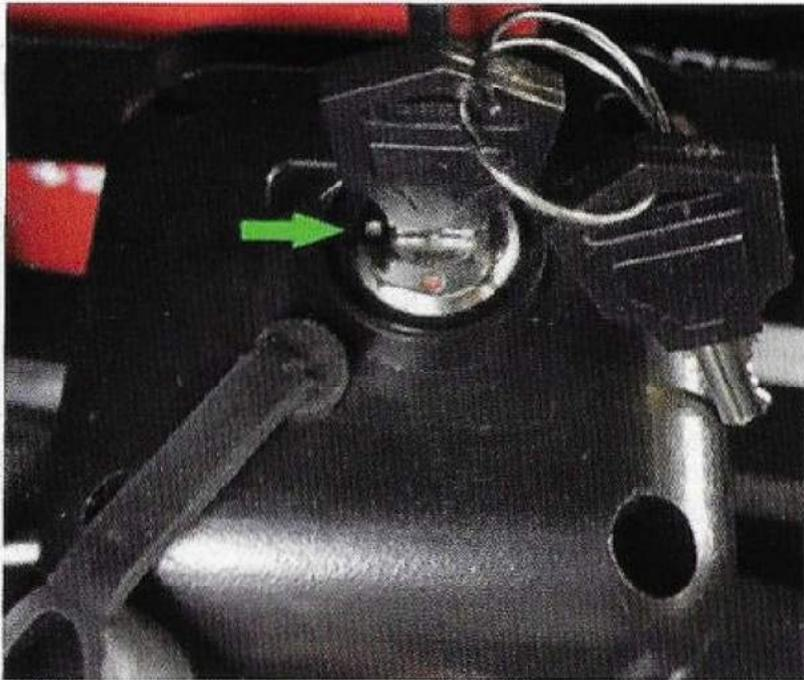
2. Deaktivierung der Selbstschutzfunktion durch Drehen des mitgelieferten Schlüssels vor die Stellung " . " (roter Punkt):
