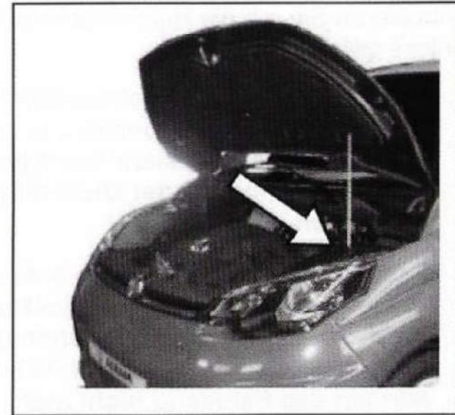
Haken Sie den Sicherungsstab aus und befestigen ihn wieder in der Halterung, ziehen Sie dann die Motorhaube ca. 50 cm nach unten und lassen nun los: Die Motorhaube schließt sich durch ihr Eigengewicht.
