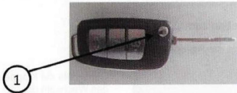
Zwei Schlüssel werden geliefert, ein Standardschlüssel und einer mit integrierter Funkfernbedienung; auf dem Piktogramm sind die Knöpfe für Öffnen und Schließen klar gekennzeichnet. Der kleine runde Knopf (1) löst den Schlüssel aus der schützenden Hülle.
