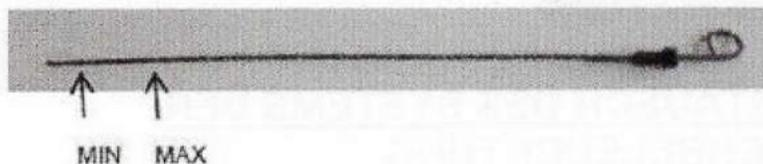
Ziehen Sie den Ölmesstab heraus und wischen Sie ihn mit einem sauberen Lappen ab. Stecken Sie den Stab bis zum Anschlag hinein.
