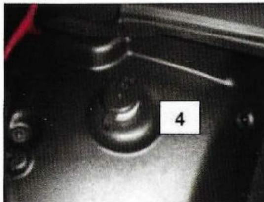
Füllen Sie bei Bedarf Scheibenwaschflüssigkeit **ohne Alkohol** anhand des Einfüllstutzens „4“ nach.
